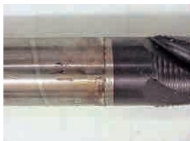
直柄的应力腐蚀
