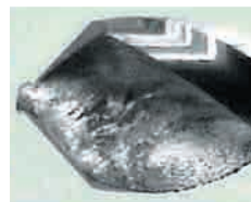
加工 26 个孔折断后钻刃上凝结明显
